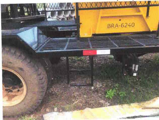
(Escada precária de acesso a plataforma/ Suporte gancho para transporte)
