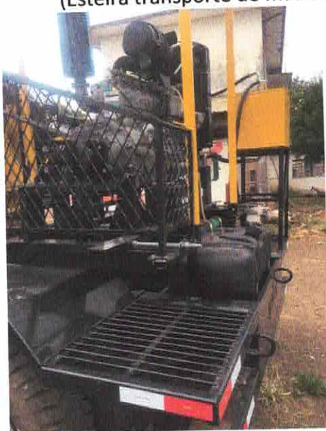
(Motor sem proteção/grade de acesso à esteira não atende a NR-12)
