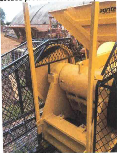
(Risco de queda e acesso sem restrição e puxador aux. de subida feito com ferro de constr. civil)
