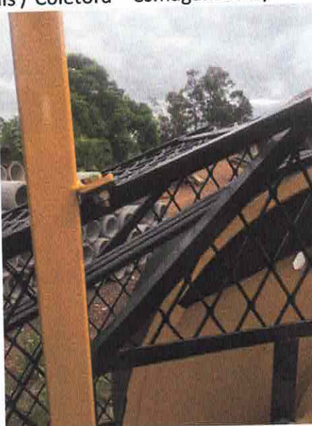
(Motor sem proteção/grade de acesso à esteira não atende a NR-12)
